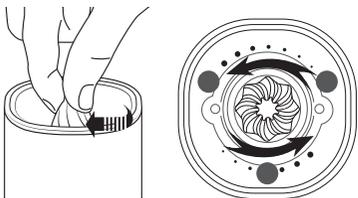
Чтобы отрегулировать степень помола, выключите мельницу переключателем питания, переверните ее перемалывающим механизмом вверх и поворачивайте регулятор степени помола.
