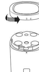
Для этого отключите прибор переключателем питания, поверните его батарейным отсеком вверх, открутите крышку батарейного отсека против часовой стрелки и установите в батарейный отсек четыре батарейки в соответствии с обозначениями полярности («+» к «+» и «-» к «-»).
